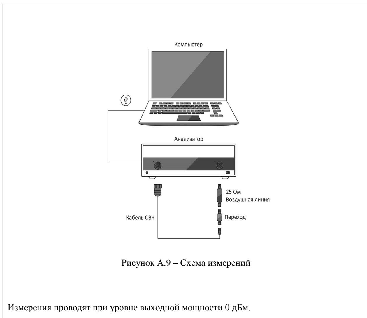
Определение абсолютной погрешности измерений модуля и фазы коэффициента отражения (метод 2, продолжение)
