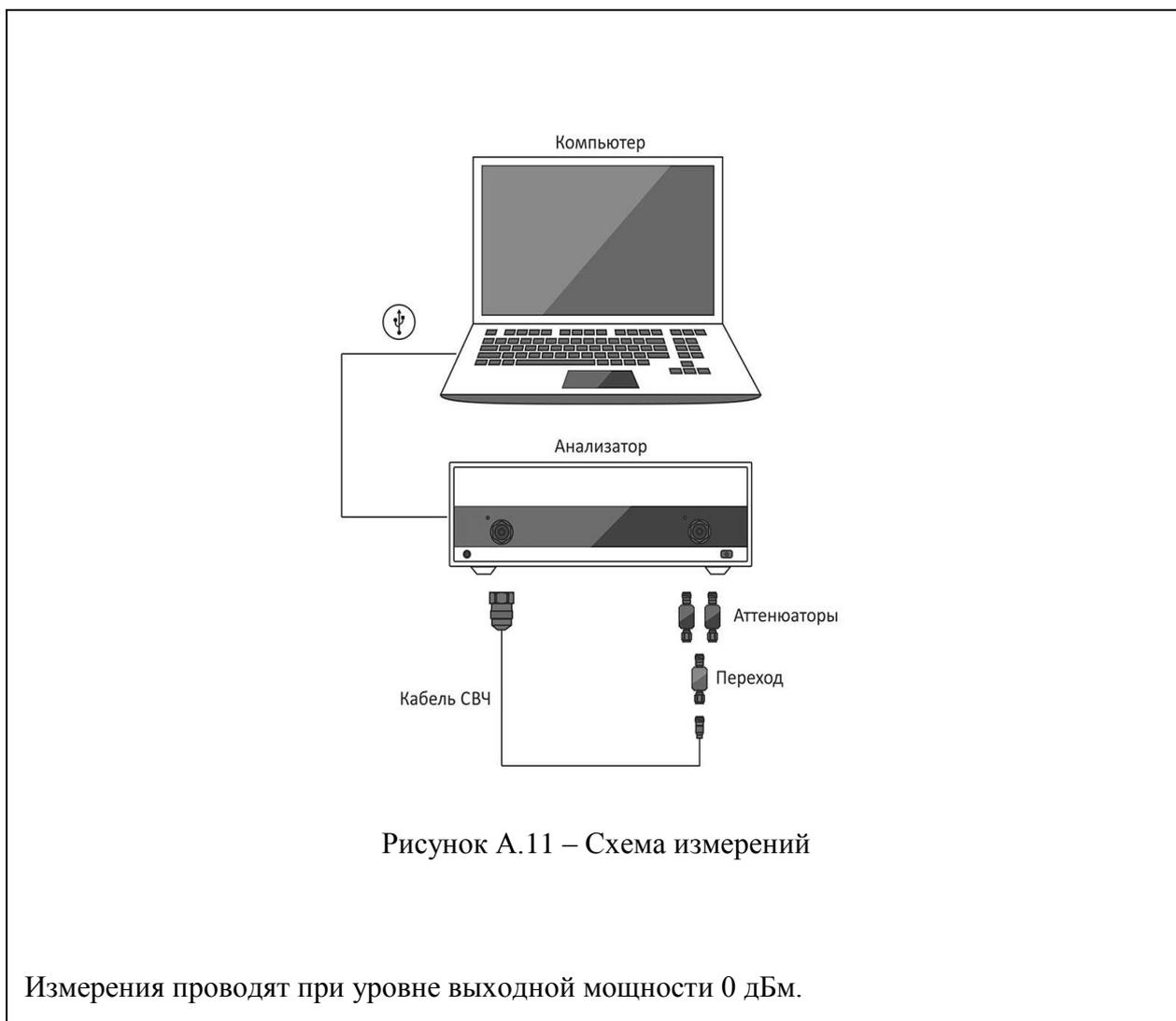
Определение абсолютной погрешности измерений модуля и фазы коэффициента передачи
