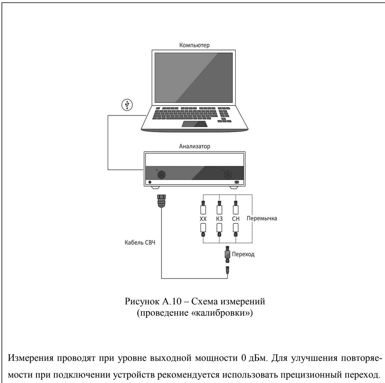
Определение абсолютной погрешности измерений модуля и фазы коэффициента передачи
