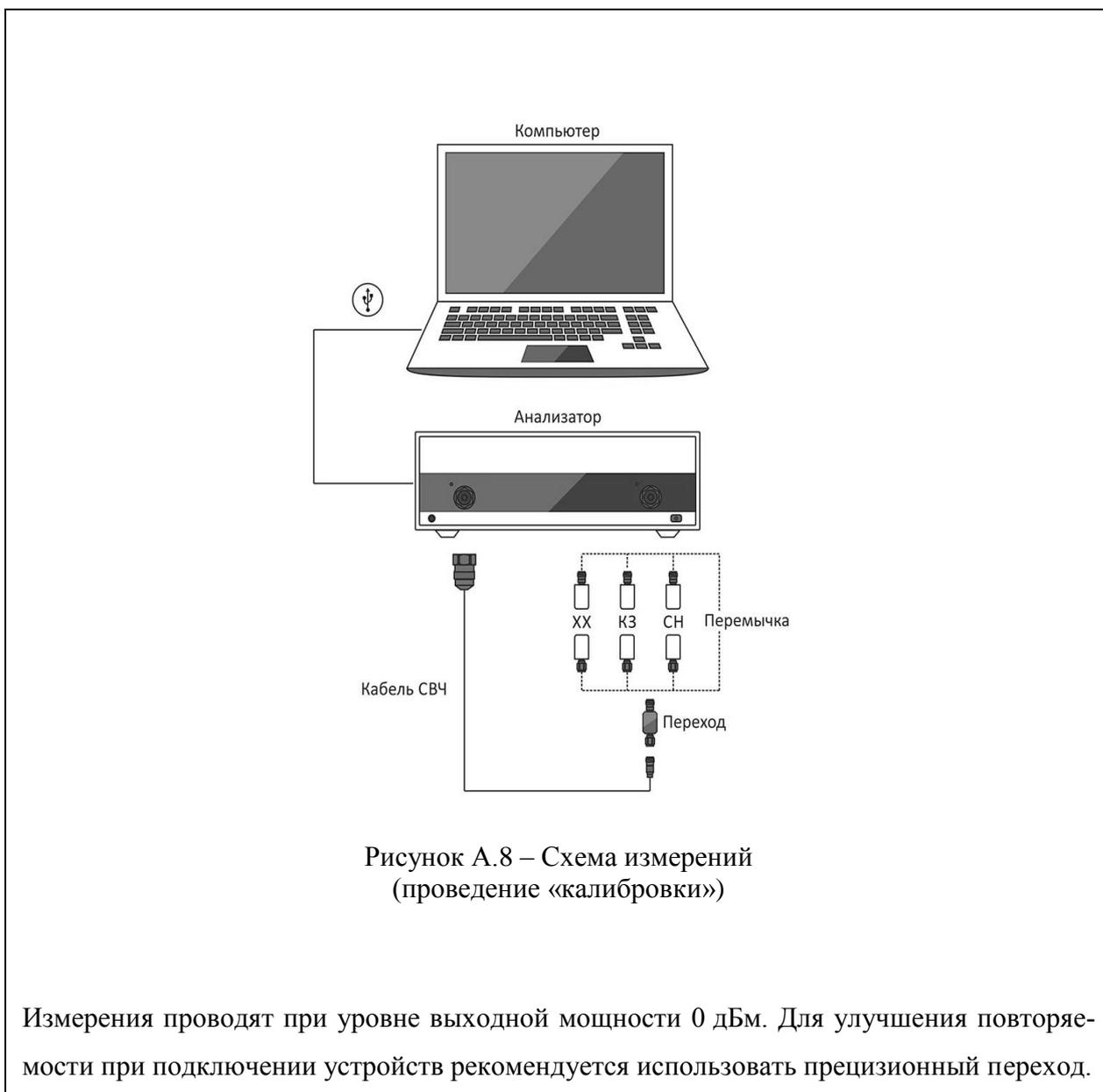
Определение абсолютной погрешности измерений модуля и фазы коэффициента отражения (метод 2, продолжение)
